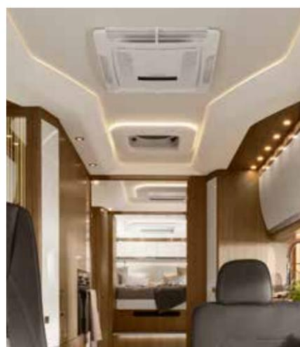
Die Dometic FreshJet 3000 ist mit einem innovativen zweizylindrigen Inverterkompressor ausgestattet. Die patentierte Technologie minimiert Vibrationen und ist wesentlich leistungsstärker als konventionelle Kompressorausführungen.
